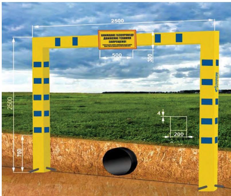
Информационно-предупреждающий знак, заглубленный в грунт над подземным сооружением, представляющий собой П-образную стойку, в поперечном сечении квадрат со стороной 200 мм. Стандартная высота стойки от отметки уровня заглубления в грунт составляет 2000 мм. Величина заглубления стойки в грунт составляет не менее 500 мм. Стойка изготовлена из цельнотянутого полимерного материала, не поддерживающего горение.
