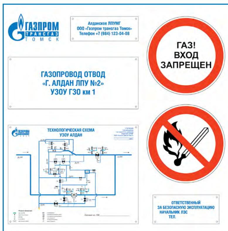
Комплекты знаков и табличек предназначены для установки на ограждения узлов линейной части магистральных газопроводов в соответствии с п.п. 5.7.20, 6.2.10 «Правил эксплуатации магистральных газопроводов» СТО Газпром 2-3.5-454-2010.
