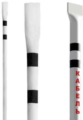
Предназначен для установки на загородных участках кабельной трассы для маркировки ее прохождения, а также для отметки местоположения муфт, поворотов трассы и маркировки концов труб, проложенных под дорогами. Дополнительно, столбик замерный устанавливается для отметки мест стыков строительных длин кабеля, если его монтируют не сразу после прокладки.
