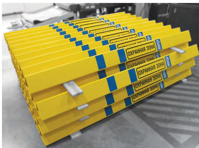
Знаки информационно-предупреждающие предназначены для обозначения границ охранной зоны, объектов (оборудования), мест пересечения с различными типами коммуникаций, мест поворота, указания километража и чтения его при вертолетном патрулировании, пограничных и иных отметок на трассах трубопроводов. Величина заглубления стойки в грунт составляет не менее 500 мм. Стойка изготовлена из пластикового композита, материала стойкого к выгоранию.
