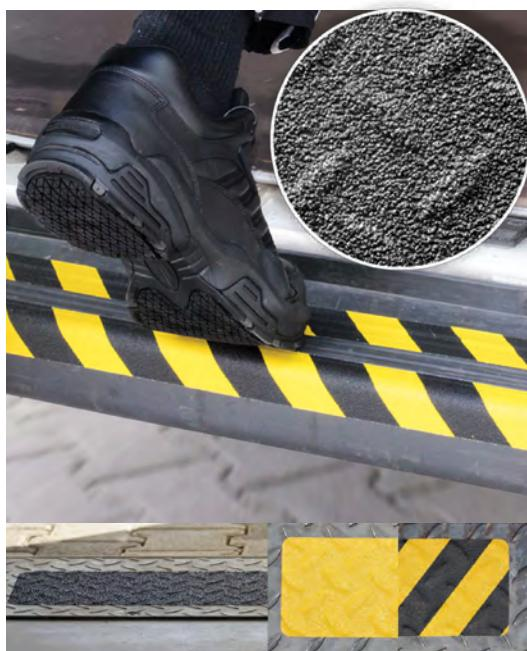
Гибкая алюминиевая подложка принимает форму неровной поверхности. Основа из ПВХ, противоскользящее покрытие с зерном из оксида алюминия, самоклеящаяся сторона с защитной лентой для защиты клеевого слоя, акриловый клеевой слой, толщина без защитной пленки менее 1 мм.
